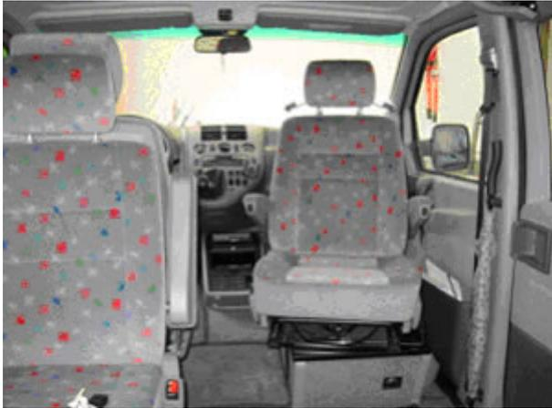
im Bild oben ist der fertige "Zweiarmlehensitz" auf einen Sportscraft Drehsitzsockel zu sehen. An der Kopfstützte wurde zudem ein V-Klasse Kleiderbügel montiert.
