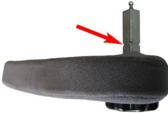
Bei diesen Sitzen ist es günstiger zuerst die komplette Lehne abzuziehen und danach den Sprengring, der die Welle an der Lehne hält, mit einem Schraubenzieher zu lösen. Es kann sonst passieren, dass beim gewaltsamen Herausziehen der Welle der Ring zerstört wird. (Siehe Bild). Die Lehne geht mit einem Ruck abzuziehen, der Vierkant ist nur gerastet. (Siehe Bilder).
