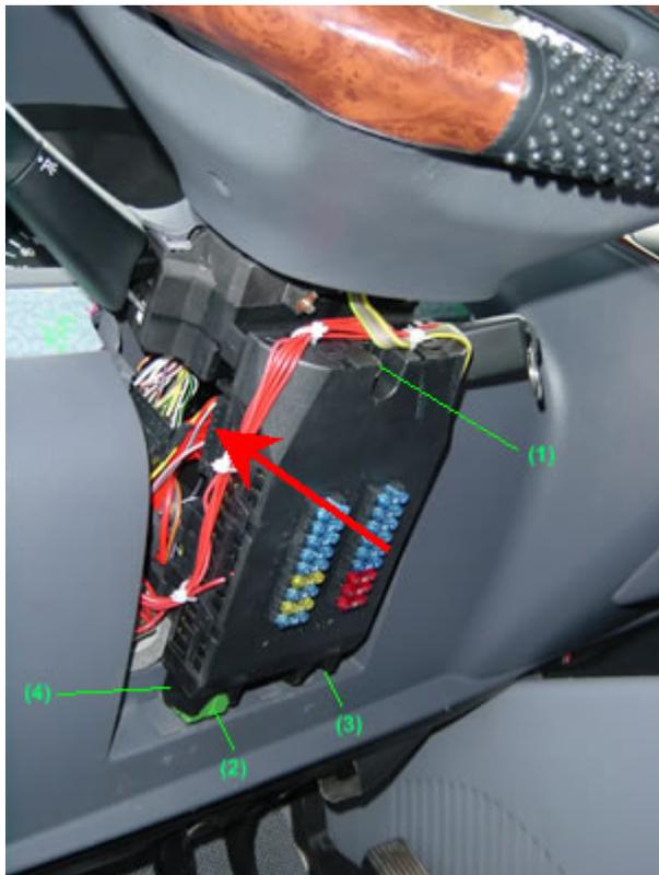
Hier werden 2 Kabel vom Relais an den oberen Stecker der Zentralelektrik angeschlossen:
