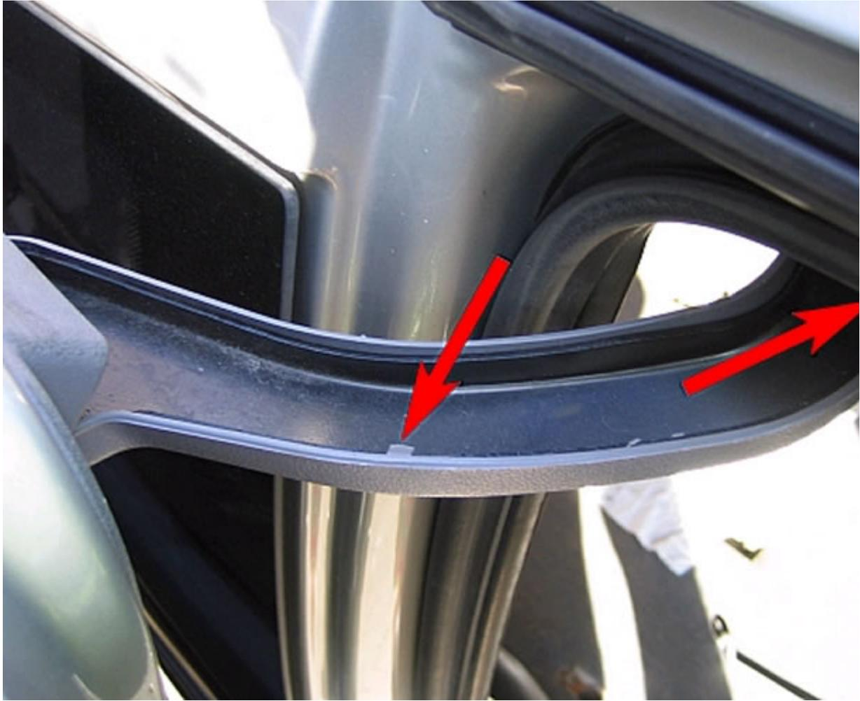
Jetzt die 2 Schrauben (M8 / SW 13) (Bild 6) am unteren Türlauf vollständig lösen (keine Angst, die Tür kann nicht herunterfallen, die Halterungen sind ineinander geschoben, die Schrauben halten nichts, sie dienen nur der Arretierung).
