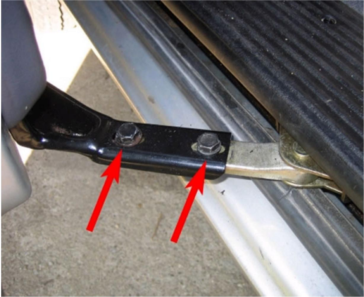
Nun am oberen Türlauf eine der beiden Imbusschrauben (M8 / 6 mm Imbus) vollständig lösen und die andere leicht lockern. (Bild 7)
