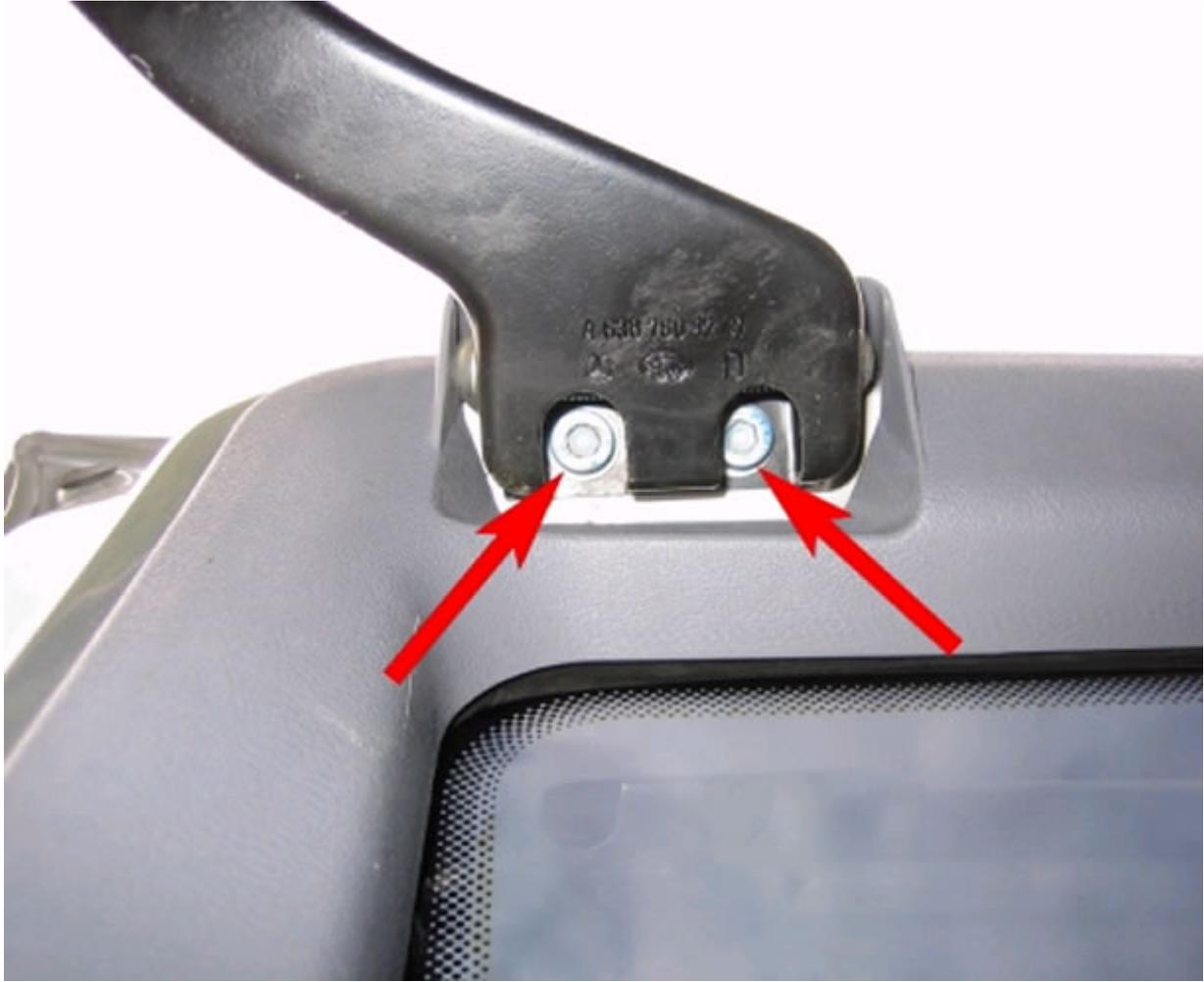
Zum Lösen der Halterung des mittleren Türlaufes empfiehlt es sich, daß einer die Tür von draußen festhält und der andere von innen die Schraube (M 10 / SW 16) der Halterung abschraubt (Bild 8).
