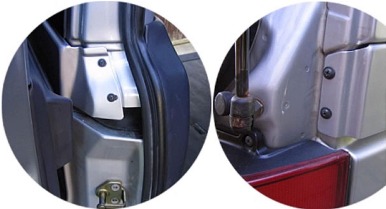
Die Schiebetür leicht öffnen und die 2 Schrauben (Kreuzschlitz) am Griff lösen. (Bild 2)
